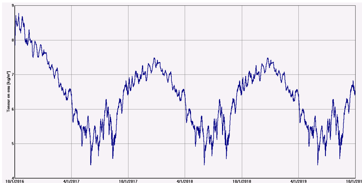
Figure 5 : Évolution de la teneur en eau (kg/m 3 ) au sein des 5 premiers centimètres de cellulose (depuis l'extérieur)
